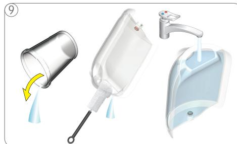
Iztukšojiet un iztīrīt krūzi. Izskalojiet un iztīrīt ūdens tvertni. Pēc tam iepildiet svaigu dzeramo ūdeni un ievietojiet to ierīcē.
