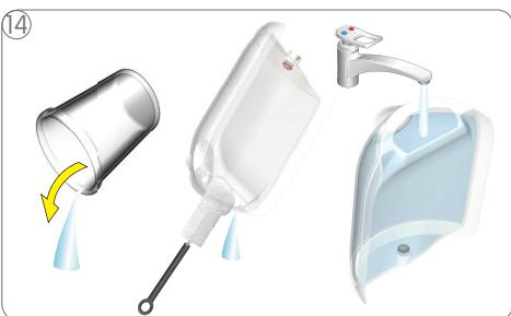
Iztukšojet un iztīriet krūzi. Izskalojiet un iztīriet ūdens tvertni. Pēc tam iepildiet svaigu dzeramo ūdeni un ievietojiet to ierīcē.
