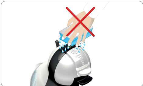
⚠ Ierīces galvas tīrīšanai izmantojiet tīrīšanas salvetes. Nelietojiet mitro sūkli!
