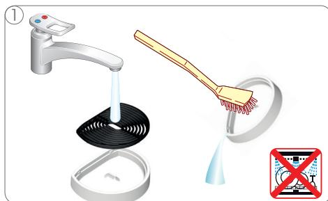
Izskalojiet ūdens pilienu paliktni ar ūdeni un iztīriet to ar birsti.
