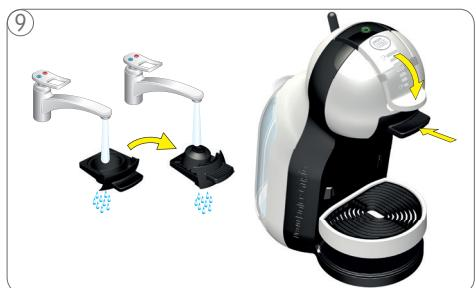
Izskalojiet kapsulas turētāju ar ūdeni un izkaltējiet no abām pusēm. levietojiet kapsulas turētāju ierīcē. Izbaudiet dzērienu!
