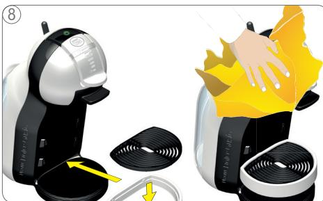
Novietojiet ūdens pilienu uztvērēju uz ūdens pilienu paliktna. Pēc tam uzstādīet ūdens pilienu paliktni vēlamajā pozīcijā. Notīriet ierīci ar mīkstu, mitru drāniņu. Pēc tam noslaukiet to ar mīkstu, sausu drāniņu.
