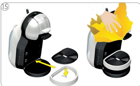
Novietojiet ūdens pilienu uztvērēju uz ūdens pilienu paliktni. Pēc tam uzstādiet ūdens pilienu paliktni vēlamajā pozīcijā. Nošķirt ierīci ar mīkstu, mitru drāniņu. Pēc tam noslaukiet to ar mīkstu, sausu drāniņu.
