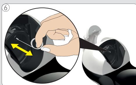
Izmantojot tīrišanas adatu, atbloķējiet sprauslu.
