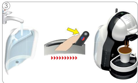
Pārbaudiet vai ūdens tvertnē ir ūdens: ja nav, ieļejet ūdeni un pārvietojiet sviru pozīcijā karsts/auksts, lai turpinātu pagatavošanu; ja ir, turpiniet:
