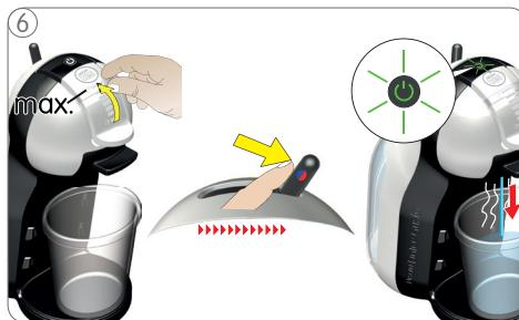
Ar tilpuma selektora palīdzību joslu displeju uzstādīet uz maksimālo līmeni. Lai sāktu skalošanu, pārvietojiet sviru pa labi.
