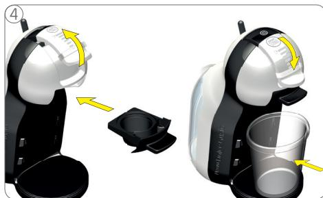
Atveriet fiksējošo rokturi un ievietojiet tukšu kapsulas turētāju. Aizveriet slēga rokturi. Zem atveres novietojiet 1 litra krūzi.
