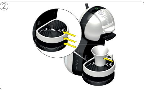
Noregulējiet ūdens pilienu paliktni saskaņā ar izvēlēto dzērienu (skat. 6-7 lpp.). Novietojiet krūzi uz ūdens pilienu paliktna.
